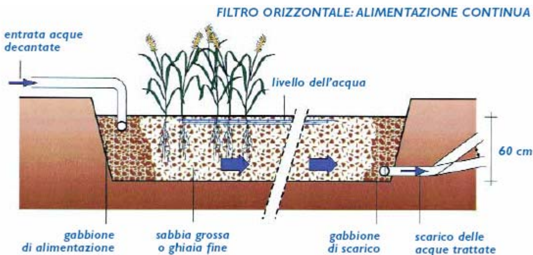
Figura 3: Schema di sistemi a flusso subsuperficiale orizzontale
